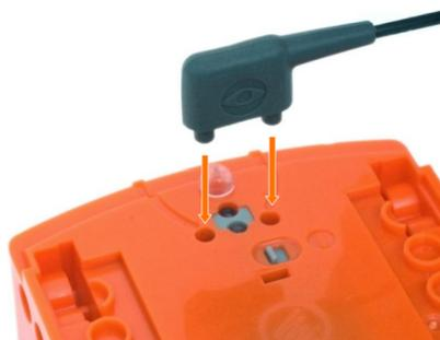
Le câble EdComm est utilisé pour charger des programmes vers Edison. Il se connecte dans une prise de casque audio sur ton ordinateur ou ta tablette.
