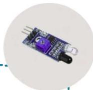
C'est un autre moyen de transmission des données sans fil qui exploite la lumière. Il est très utilisé pour les télécommandes.
