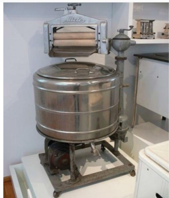
Autre machine datant de 1930. Elle est dotée d'un moteur électrique et d'une cuve métallique, mais reste fonctionnellement équivalente au modèle précédent.
