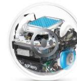
Les élèves pilotent cette balle robotique en dessinant, codant ou en programmant par blocs. À la différence de SPRK+, BOLT est muni d'une matrice LED 8x8 qui anime et affiche des données en temps réel.
