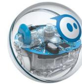
Sphero SPRK+ est une balle robotique rapide munie de capteurs et transparente. Téléguidable par smartphone, les élèves peuvent lui créer des parcours sur terre et dans l'eau !
