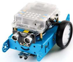
Ce robot allie programmation, électronique et robotique ! Le robot mBot est évolutif : assemblez les pièces, ajoutez des capteurs et connectez-le via bluetooth au logiciel Mblock pour augmenter vos possibilités de programmation. Il est livré avec sa batterie rechargeable. Un robot parfait pour monter des projets de robotiques.
